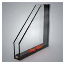
Nous équipons nos fenêtres en standard avec le double vitrage isolant Plus-Valor. Un des deux verres est revêtu d'un traitement faiblement émissif et l'espace entre les verres est rempli de gaz argon.
