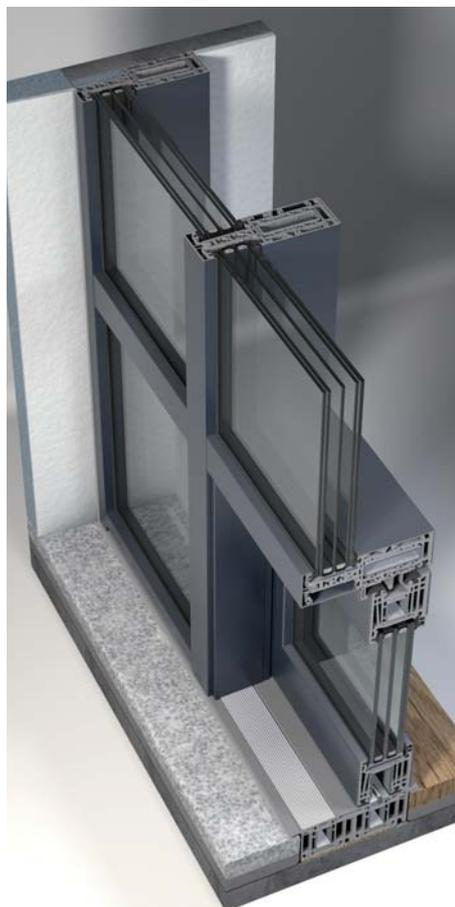
Une solution astucieuse et flexible pour des solutions innovantes : les généreuses surfaces vitrées sont combinées ici avec des portes levantes coulissantes, permettant une esthétique filigrane semblable à celle d'une façade avec montants et traverses. La construction de base repose sur des profils PVC isolants avec renfort acier dotés sur les deux faces d'un capotage aluminium. Chaque face peut être exécutée dans une teinte différente, permettant ainsi de personnaliser la réalisation.
