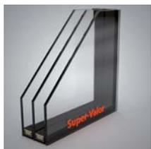
Super-Valor est un vitrage aux prestations thermiques exceptionnelles. Le revêtement faiblement émissif sur deux verres confère à ce triple vitrage d'excellentes propriétés d'isolation thermique durant les mois d'hiver. Et en été il maintient le frais à l'intérieur de l'habitation.
