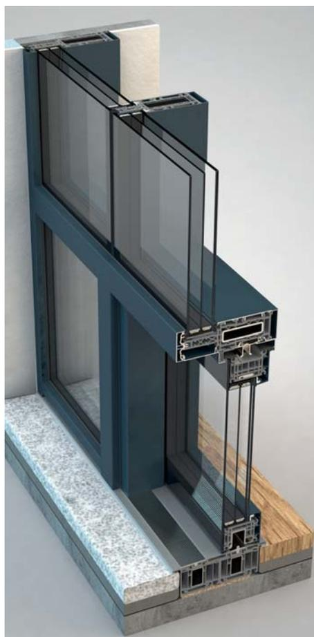
Pour les amateurs de design, nous déclinons également un modèle Cristal de notre façade vitrée : ici, les fins contours des montants ou traverses disparaissent presque entièrement derrière le vitrage à bords décalés. L'absence de profils de maintien à l'extérieur permet d'obtenir une surface entièrement vitrée dont l'orientation peut être horizontale ou verticale, selon votre préférence.
